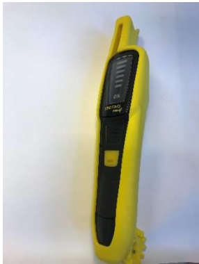
Spänningsindikator UNITAGUFE Längd: 275 mm Vikt: 0,21 kg
